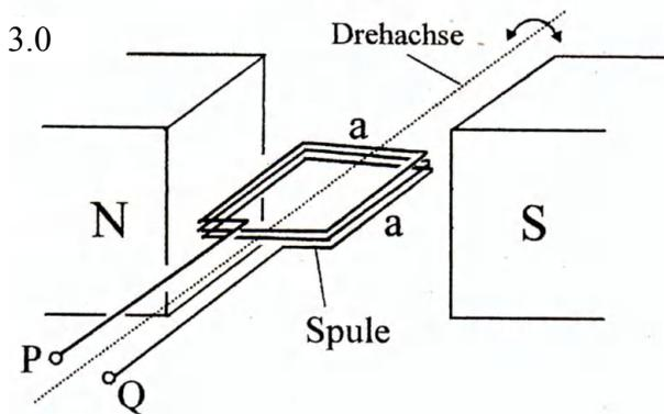
Eine flache Spule hat die Windungszahl  $N_S$  und einen quadratischen Querschnitt mit der Seitenlänge  $a$ . Diese Spule befindet sich im homogenen Magnetfeld zwischen einem Nordpol N und einem Südpol S (siehe nebenstehende Skizze). Die magnetische Flussdichte  $\vec{B}$  ist zeitlich konstant und hat den Betrag  $B$ .
